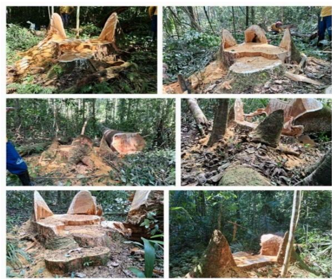
Figura 04 - Corte com técnicas de derruba direcionada
